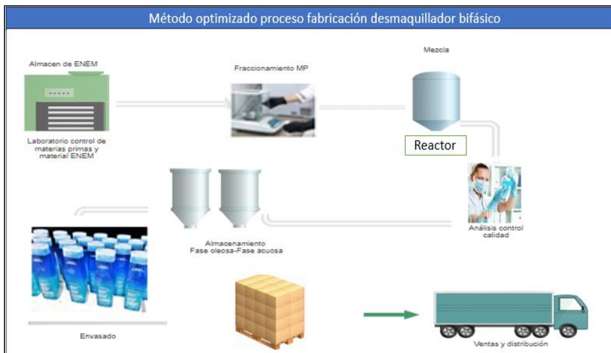
Figura 16. Método de optimización del proceso de fabricación de la loción desmaquillante bifásico.
